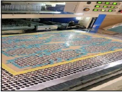
Während der Einrichtung konfiguriert sich die Maschine innerhalb von 15 Minuten anhand einer Vorlage (links), die basierend auf dem Stanzbogen vom Bediener erstellt wird.
