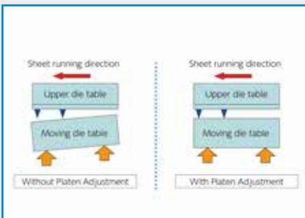
**Module 2 de l'APC :** basculement de la platine en sortie
